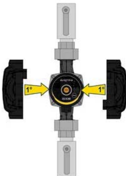
Obrázok 7: Izolácia telesa čerpadla
