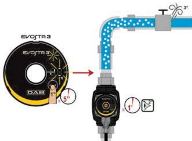
Obrázok 9: Automatické odvzdušnenie čerpadla
