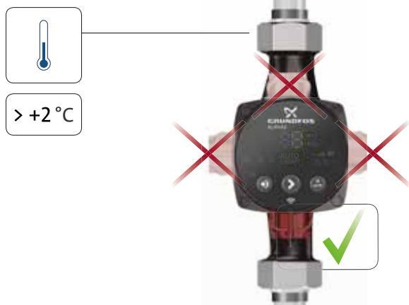
Obr. 4 Poloha svorkovnice, v klimatizačné systémy a systémy so studenou vodou
